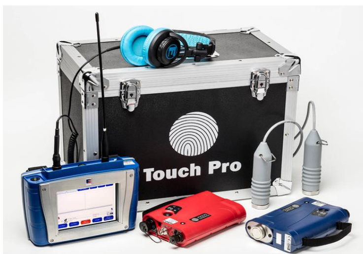
Zdj. 8.1 ZWiK – Korelator sieci wodociągowych
